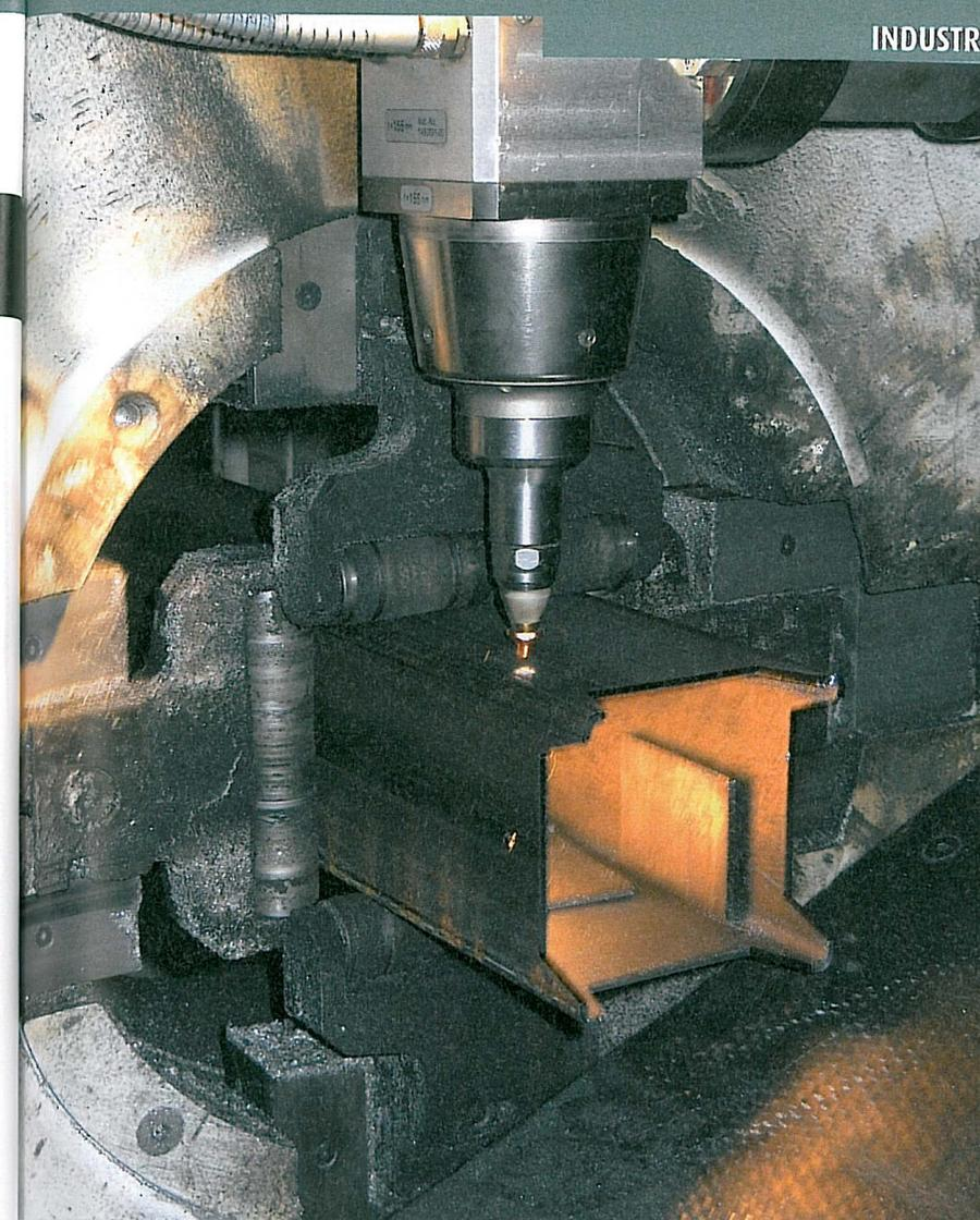
rectangulaires, carrés ou alors profilés. En découpant des formes « intelligentes » sur un profilé, on peut réaliser d'un seul tenant des pièces qui étaient auparavant le résultat d'un assemblage de plusieurs tubes.
