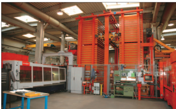
▲ Au sein du parc machines de L.A.P., on trouve 2 lasers Bystronic Bystar respectivement de 2,8 et 4 kW ainsi qu'un Byspeed de 4,4 kW. Ces 2 derniers sont connectés à une tour de stockage permettant d'assurer leur chargement/déchargement de manière automatique.
