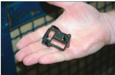
▲ Pièce plastique retouchée au laser pour assurer sa fonction.
